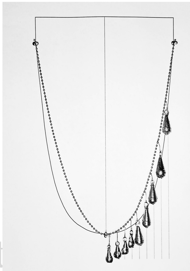
Fotografia de la maqueta d'estudi carregada amb els pesos de cada tram a escala
